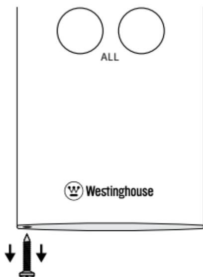
À l'aide d'un tournevis cruciforme, retirez la vis située à la base de la télécommande.
