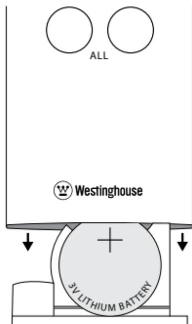
Retirez le bac du boîtier distant. Insérez une nouvelle pile au lithium CR2032 dans le porte-pile. Assurez-vous de placer correctement le + (côté positif de la batterie) face vers le haut. Repoussez le plateau dans le boîtier à distance et fixez-le en place avec la vis.
